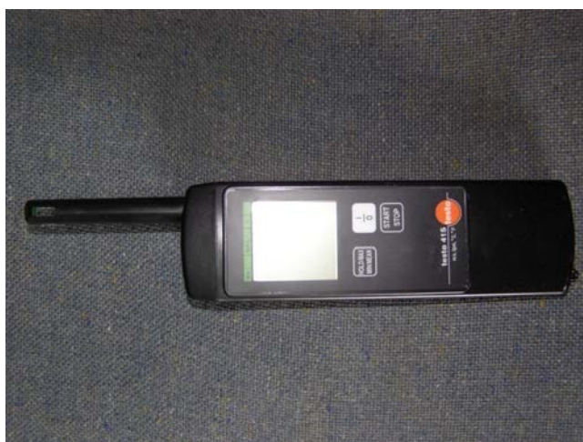
รูปที่ 4.8 เครื่องวัดอุณหภูมิและความเร็วของอากาศแบบมือถือ
