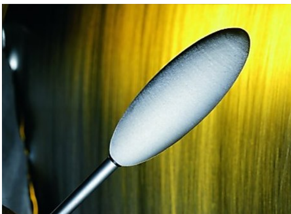
รูปที่ 4.12 หัววัดอุณหภูมิโอเปอร์เรทีฟที่อยู่ในตำแหน่งจำลองสภาพนั่ง
