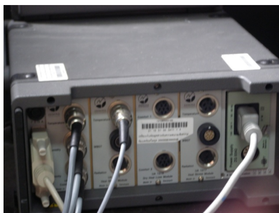
รูปที่ 4.6 เครื่องบันทึกข้อมูลความสบายเชิงความร้อนที่แสดงด้านหน้า และด้านหลังของมอดูล
