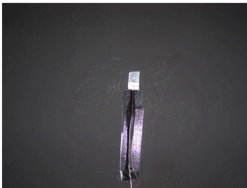
รูปที่ 4.4 การติดตั้งเทอร์มอคัปเปิลที่ใช้วัดอุณหภูมิผิวห้อง
