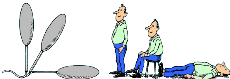
รูปที่ 4.13 ตำแหน่งของหัววัดอุณหภูมิโอเปอร์เรทีฟที่มุมเอียงต่างๆ ที่จำลองลักษณะของคน[43]
