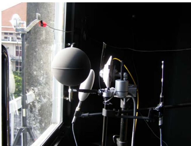
รูปที่ 4.14 ลักษณะการติดตั้งเครื่องมือวัดภายในห้องทดลอง
