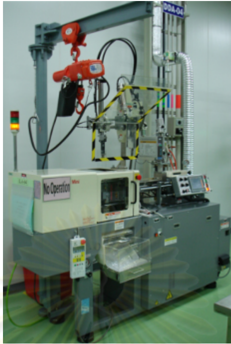
รูปที่ 1-15 เครื่องกัดขนาดแรงที่ใช้ปัดโมล 7 ตันสำหรับกัดโมล CHI และ J (4 คาวิตี)
