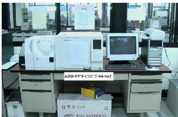
ภาพที่ 3.7 เครื่อง Gas Chromatography-Mass Spectrometry (GC-MS) รุ่น A SHIMADZU GC-MS QP2010
