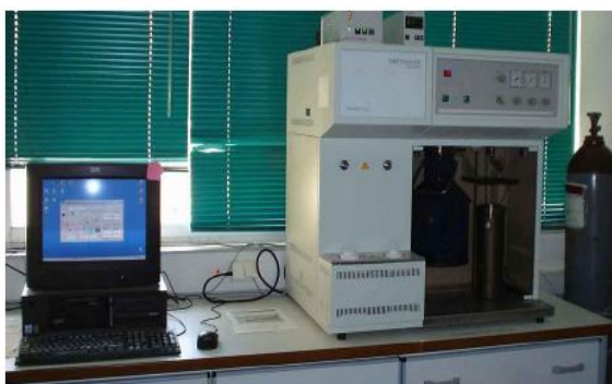
ภาพที่ 3.6 เครื่องวิเคราะห์พื้นที่ผิวรูพรุนทั้งหมด (BET surface area)
