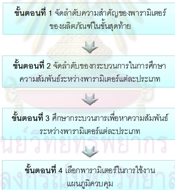
รูปที่ 3.3 ขั้นตอนในการจัดลำดับความสำคัญของกระบวนการและเลือกพารามิเตอร์ในการใช้แผนภูมิควบคุม
