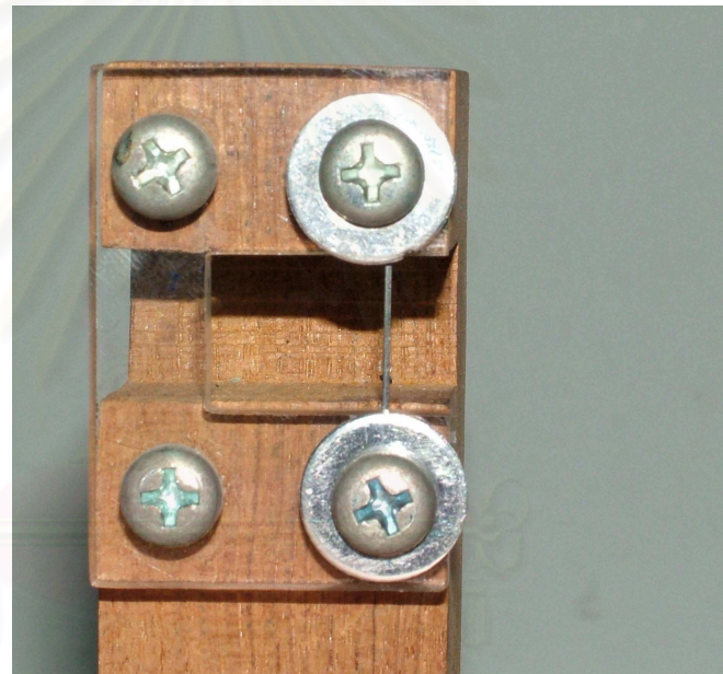
รูปที่ 27 การยึดลวดกับเครื่องมือสำหรับยึดลวดโดยติดเทปกาวใส และไขวงแหวนโลหะ
