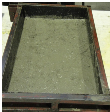
รูปที่ 3.8 แบบหล่อขนาด 35 x 57 x 10 เซนติเมตร
