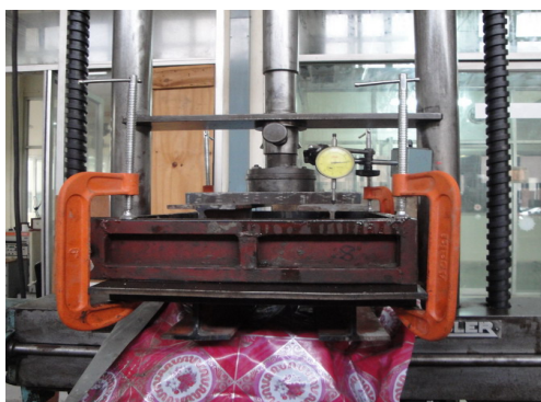
รูปที่ 3.9 การอัดขึ้นรูปแผ่นซีเมนต์เสริมเส้นใยโดยเครื่องอัดไฮดรอลิก
