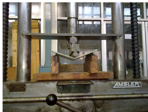
รูปที่ 3.13 การทดสอบความต้านแรงดัดของแผ่นซีเมนต์
