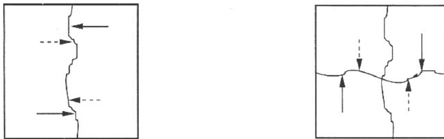
รูปที่ 3.12 ตำแหน่งการวัดความหนาที่รอยแตกหักของชิ้นทดสอบสี่เหลี่ยมจัตุรัส [มอก.1427-2540]
