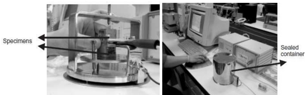
รูปที่ 3.16 เครื่องมือ Hot Disk Thermal Constant Analyzer
