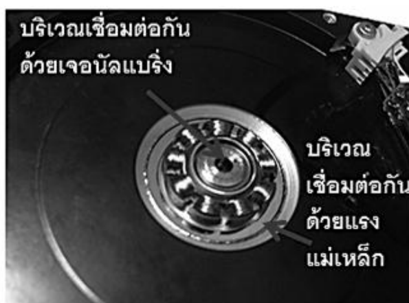
รูปที่ 72 สเตเตอร์ ซึ่งเป็นส่วนหนึ่งของระบบย่อยที่ 3 ชุดแกนควบคุมกับฐานซึ่งมีสเตเตอร์
