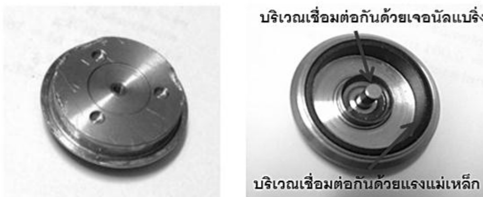
รูปที่ 73 โรเตอร์ ซึ่งเป็นส่วนหนึ่งของระบบย่อยที่ 1 ชุดแผ่นดิสก์กับ โรเตอร์
