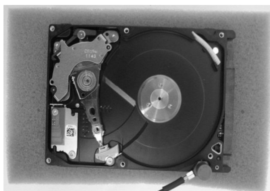
รูปที่ 40 ระบบฮาร์ดดิสก์ไดรฟ์กรณีที่ 3 ฮาร์ดดิสก์ที่ไม่มีฝาปิดบนและชุดแขนควบคุม
