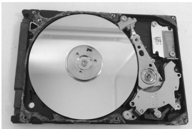
รูปที่ 74 แนวทางการลดการส่งผ่านการสั่นสะเทือนด้วยกาวยูยู
