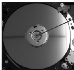
รูปที่ 5 การยึดระหว่างแผ่นดิสก์กับสปินเดิลมอเตอร์ (ตำแหน่งหัวลูกศร แสดงการยึดด้วยสกรู)
