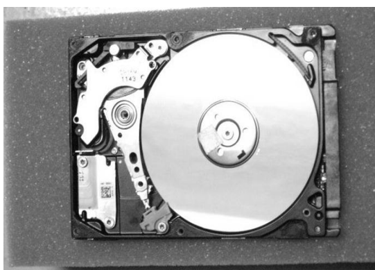
รูปที่ 39 ระบบฮาร์ดดิสก์ไดรฟ์กรณีที่ 2 ฮาร์ดดิสก์ที่ไม่มีฝาปิดบน
