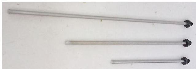
รูปที่ 102 แท่งส่งผ่านการสั่นสะเทือนขนาด 12 นิ้ว 9 นิ้ว และ 6 นิ้ว
