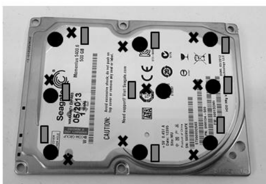
รูปที่ 54 ตำแหน่งการกระตุ้น และการวัดสัญญาณในการทดลองหาค่าสัมประสิทธิ์ของการสูญเสียพลังงานของระบบย่อยที่ 2 ฝาปิดบน
