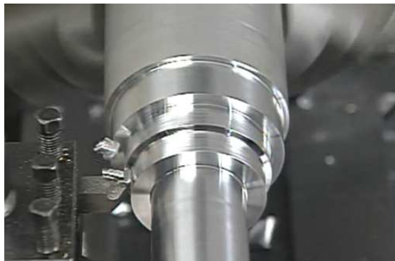
รูปที่ 2.8 : การเกิดเศษโลหะของขบวนการกลึง
