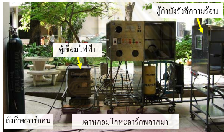
รูปที่ 4.1 เตาหลอมโลหะอาร์กพลาสมาที่สร้างขึ้น
