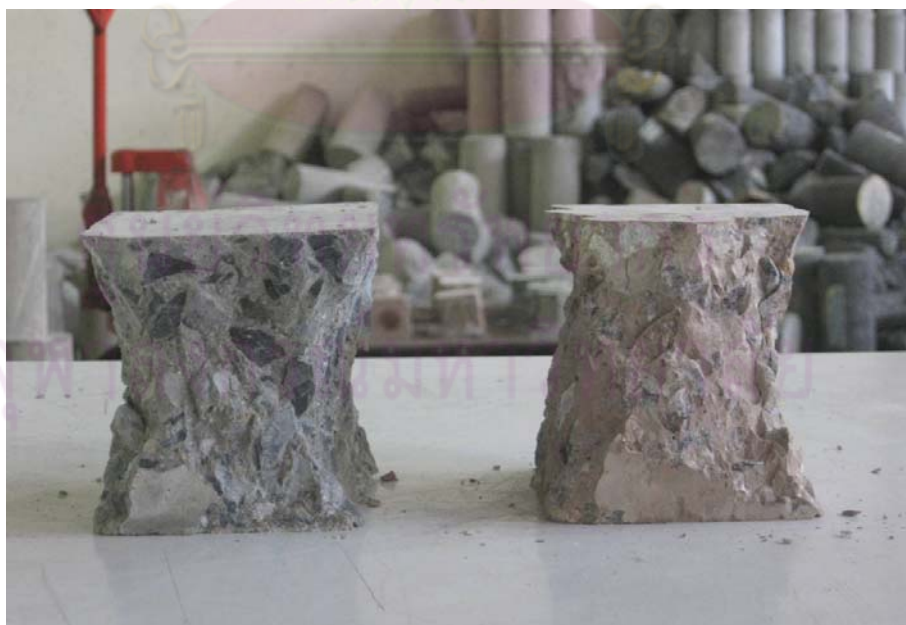
รูปที่ 3.27 ลักษณะคอนกรีตภายหลังการทดสอบกำลังอัดของคอนกรีต
