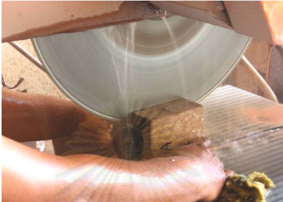
รูปที่ 3.42 การผ่าตัวอย่างคอนกรีตด้วยเครื่องตัดคอนกรีต
