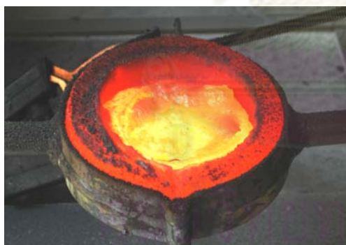
จุฬาลงกรณ์มหาวิทยาลัย รูปที่ 4.5 การหลอมโลหะเหล็ก (Fe) และออกไซด์ที่เกิดขึ้น
