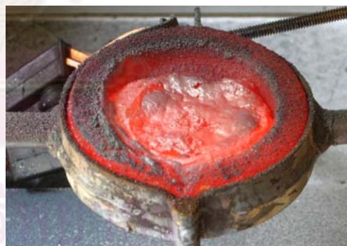
จุฬาลงกรณ์มหาวิทยาลัย รูปที่ 4.5 การหลอมโลหะเหล็ก (Fe) และออกไซด์ที่เกิดขึ้น
