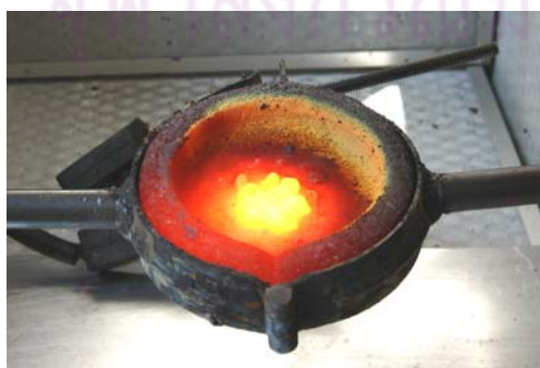
รูปที่ 4.7 การหลอมโลหะโมลิบดีนัม (Mo) และออกไซด์ที่เกิดขึ้น
