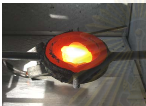
รูปที่ 4.6 การหลอมโลหะเซอร์โคเนียม (Zr) และออกไซด์ที่เกิดขึ้น
