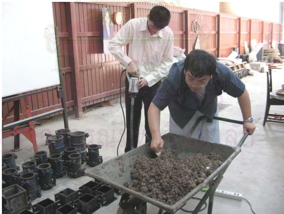
รูปที่ 3.18 การเทคอนกรีตลงในแบบหล่อคอนกรีต
