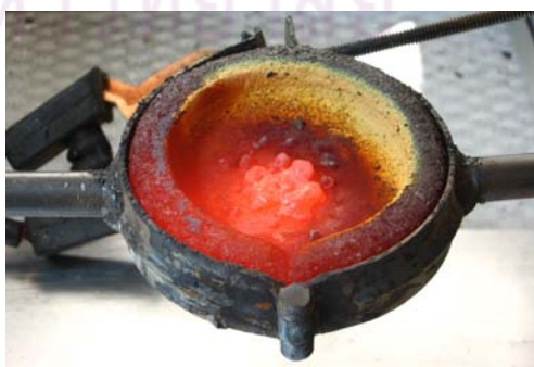
รูปที่ 4.7 การหลอมโลหะโมลิบดีนัม (Mo) และออกไซด์ที่เกิดขึ้น
