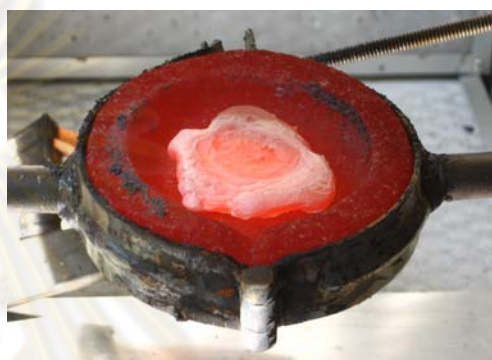
รูปที่ 4.6 การหลอมโลหะเซอร์โคเนียม (Zr) และออกไซด์ที่เกิดขึ้น
