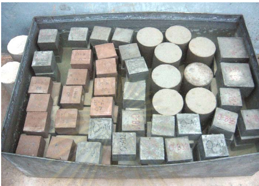
รูปที่ 3.22 การบ่มคอนกรีตในน้ำนาน 28 วัน
