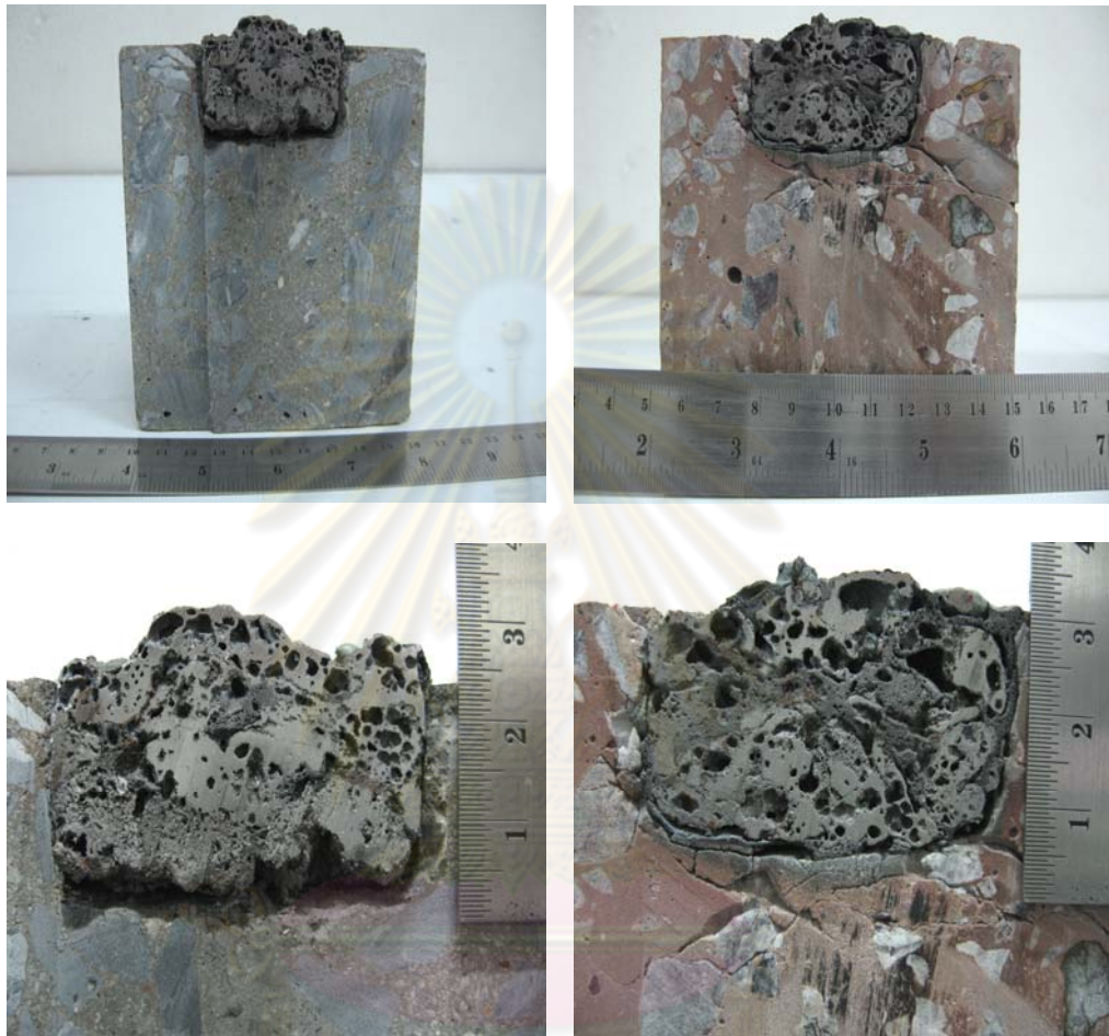
ศูนย์วิทยทรัพยากร จุฬาลงกรณ์มหาวิทยาลัย รูปที่ 4.27 ผลการผ่าคอนกรีตเมื่อเกิดอันตรกิริยากับโลหะผสม Fe:LM เท่ากับ 50:50 wt.%
