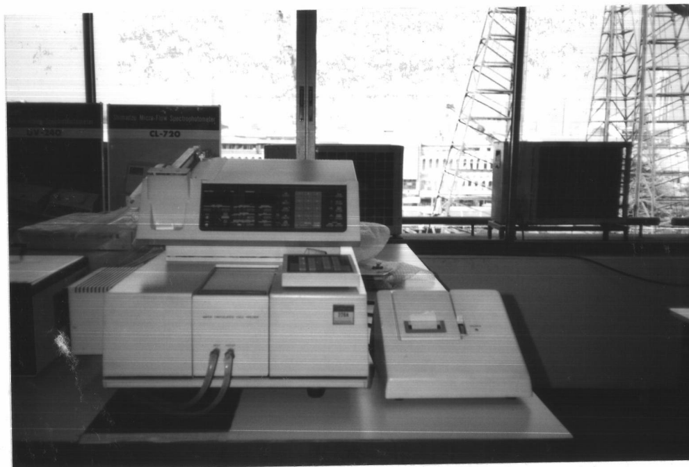
รูปที่ 12 แสดงเครื่องมือ Spectrophotometer Hitachi Model 220 A
