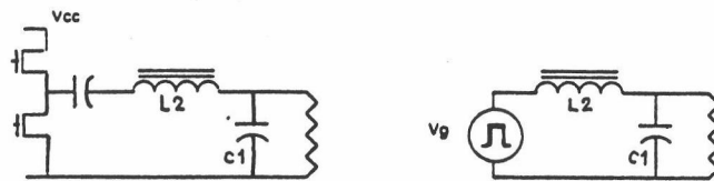
รูปที่ 3.12 วงจรอินเวอร์เตอร์ความถี่สูงที่ใช้ในการวิเคราะห์ และวงจรสมมูล
