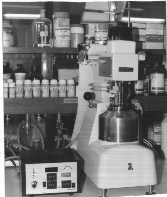
รูปที่ 3.4 Brabender Viskograph Model 8004 40
