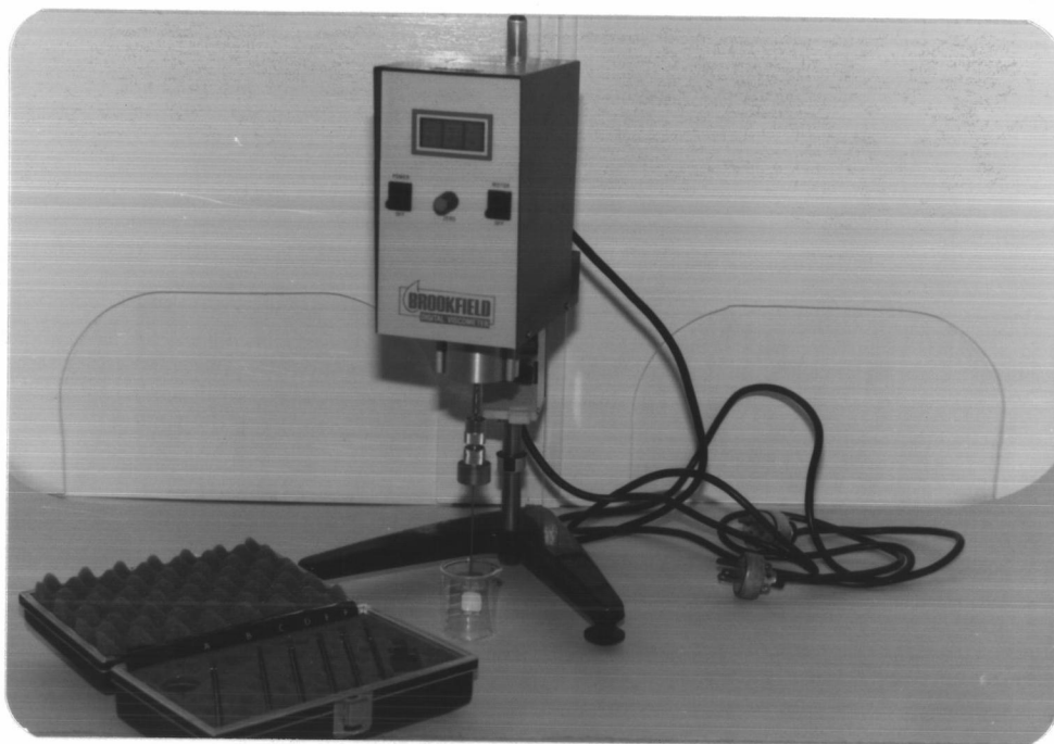
รูปที่ 3.5 Brookfield Digital Viscometer Model LVTD พร้อม Helipath Stand Model D และหัววัดรูปตัวที (T-bar)
