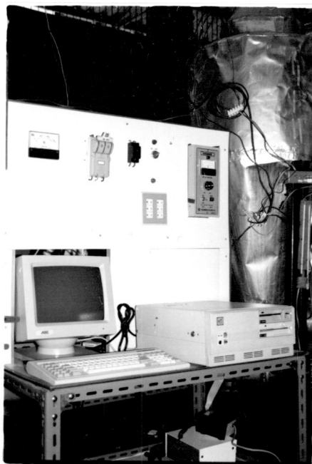
รูปที่ 3.3 แสดงแผงควบคุมการเผาไหม้ถ่านหิน และเครื่องไมโครคอมพิวเตอร์
