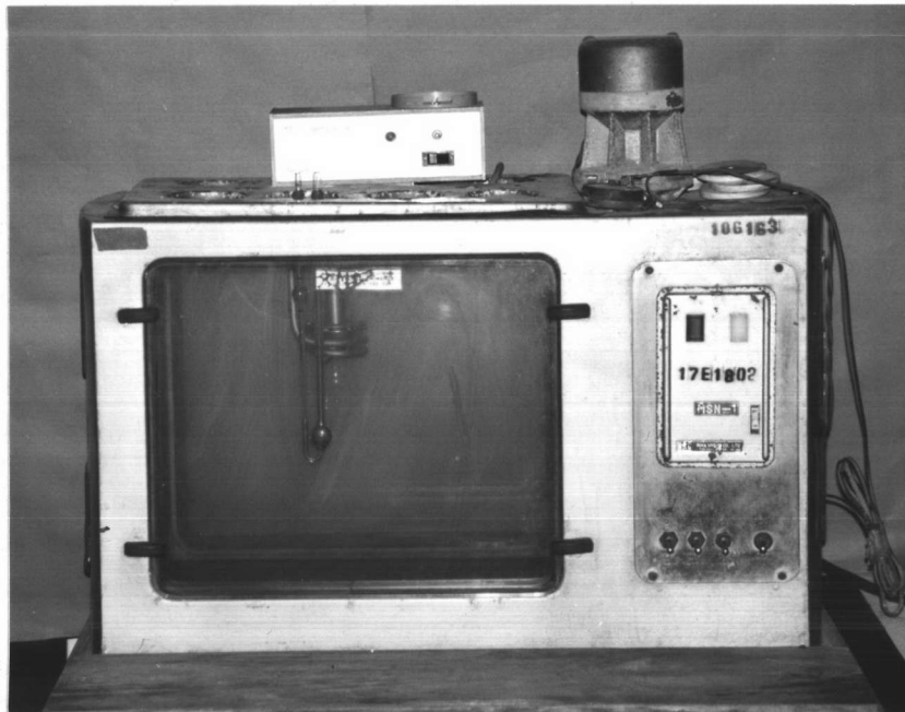
รูปที่ ก-1.2 ข้างน้ำควบคุมอุณหภูมิพร้อมกับ Ostwald viscometer
