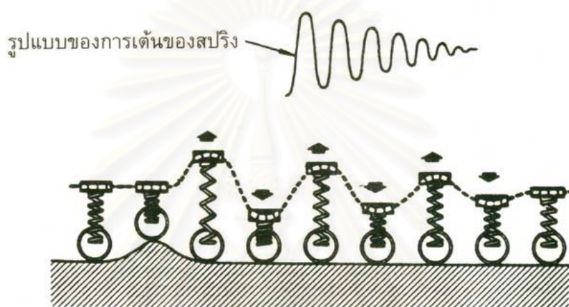
รูปที่ 2.13 ลำดับขั้นตอนการเต้นของสปริง [1]
