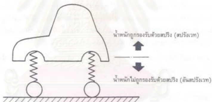
รูปที่ 2.1 ส่วนที่น้ำหนักถูกรองรับด้วยสปริงกับส่วนที่น้ำหนักไม่ถูกรองรับด้วยสปริง [1]
