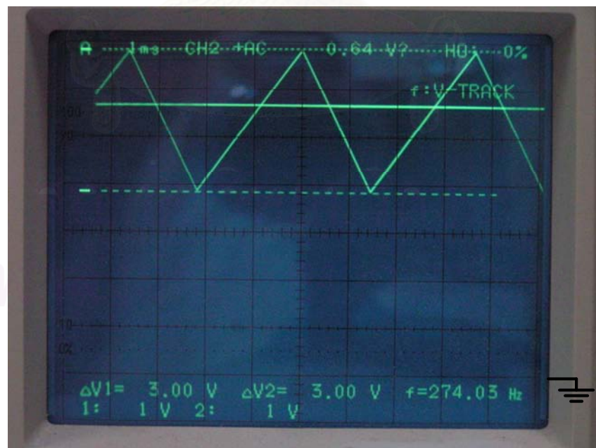
รูปที่ 4.7 รูปแบบของสัญญาณขาออกของวงจรสร้างคลื่นรูปสามเหลี่ยม เมื่อแรงดันขาเข้าอ้างอิงมีค่า 5.6 โวลต์
