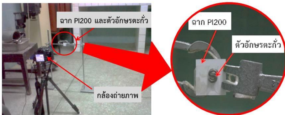
รูปที่ 3.17 การจัดระบบถ่ายภาพเบื้องต้นเพื่อทดสอบฉากเรืองรังสีชนิด PI-200 ขนาด 3 ซม. x 3 ซม.
