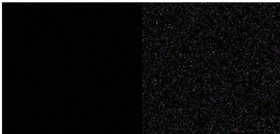
รูปที่ 4.1 วัดค่าสัญญาณรบกวนที่เกิดขึ้นเมื่อเปลี่ยนการตั้งค่า ISO 100 (ซ้าย) กับ ISO 6400 (ขวา)
