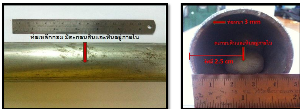
ท่อเหล็กกลม รัศมี 2.5 เซนติเมตร มีก้อนดินและหินอยู่ภายใน
