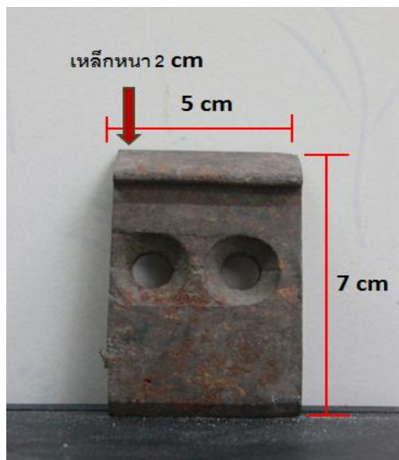
รูปที่ 3.13 เหล็กหนา 2 ซม. มีรู 2 รู
