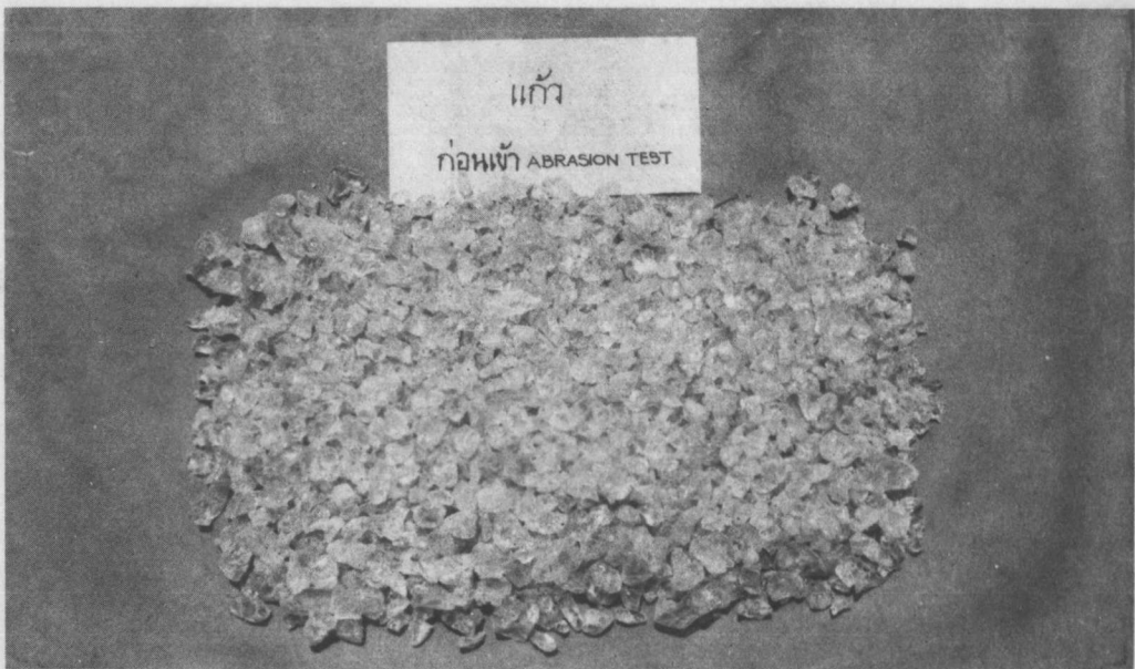
รูปที่ 3.15 แก้ว ก่อนเข้าทดลองวัดความสึกหรอ
