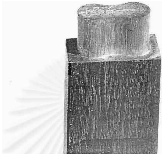
รูปที่ 4.2 ภาพชิ้นงานจริงจากแบบชิ้นงานที่ 1 ที่ได้จากกัด
