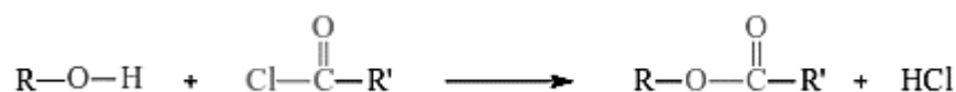
รูปที่ 2.17 ปฏิกิริยาเอสเทอร์ฟิเคชันระหว่างแอซิดคลอไรด์กับแอลกอฮอล์ [31]
