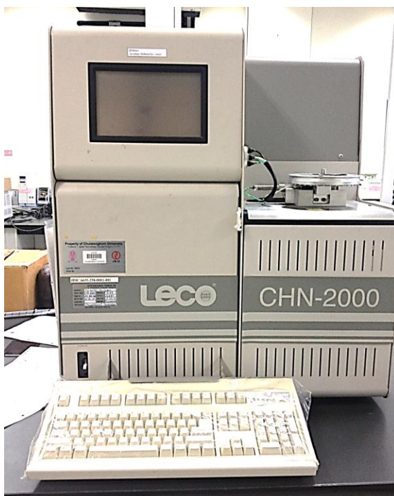
รูปที่ 3.2 เครื่องวิเคราะห์ปริมาณธาตุคาร์บอน ไฮโดรเจนและไนโตรเจน LECO® รุ่น CHN-2000
