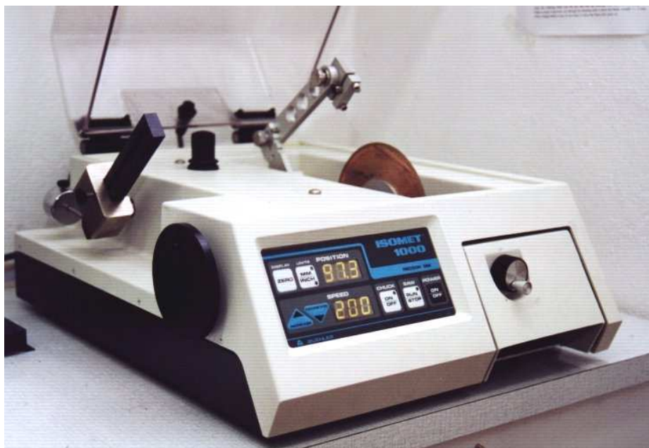
รูปที่ 3.3 เครื่อง Low speed cutting machine รุ่น ISOMET1000 ยี่ห้อ BUEHLER (Germany)
