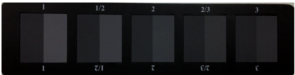
ภาพที่ 3.8 เกรย์สเกลสำหรับการวัดการเปลี่ยนแปลงของสี
