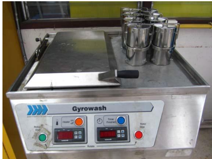
ภาพที่ 3.6 เครื่องทดสอบความคงทนของสีต่อการซัก Gyrowash
