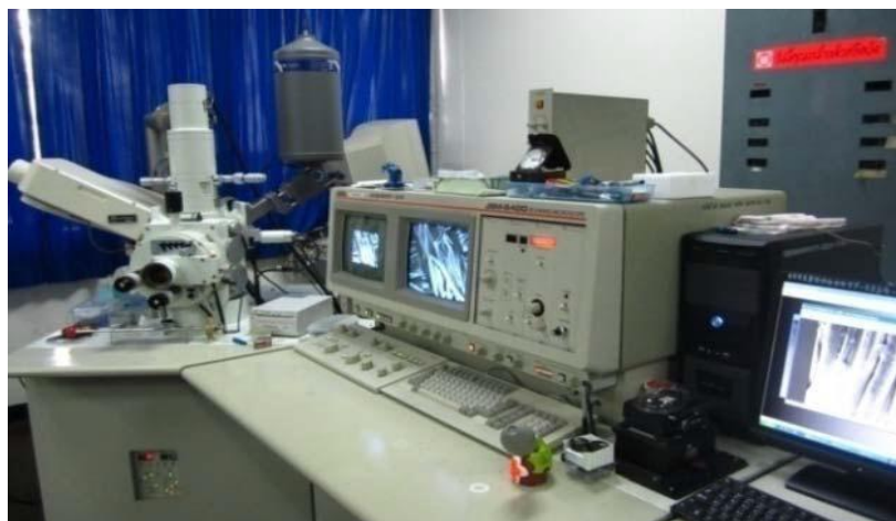
ภาพที่ 3.3 กล้องจุลทรรศน์อิเล็กตรอนแบบส่องกราด (Scanning electron microscope)
