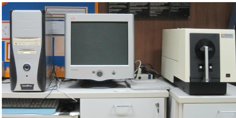
ภาพที่ 3.4 เครื่องวัดสี reflectance spectrophotometer (Macbeth Color-Eye 7000)
