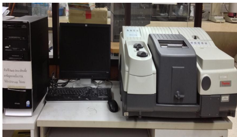
ภาพที่ 3.11 เครื่องฟูเรียร์ทรานสฟอร์มอินฟราเรดสเปกโทรโฟโตมิเตอร์ (FTIR)
