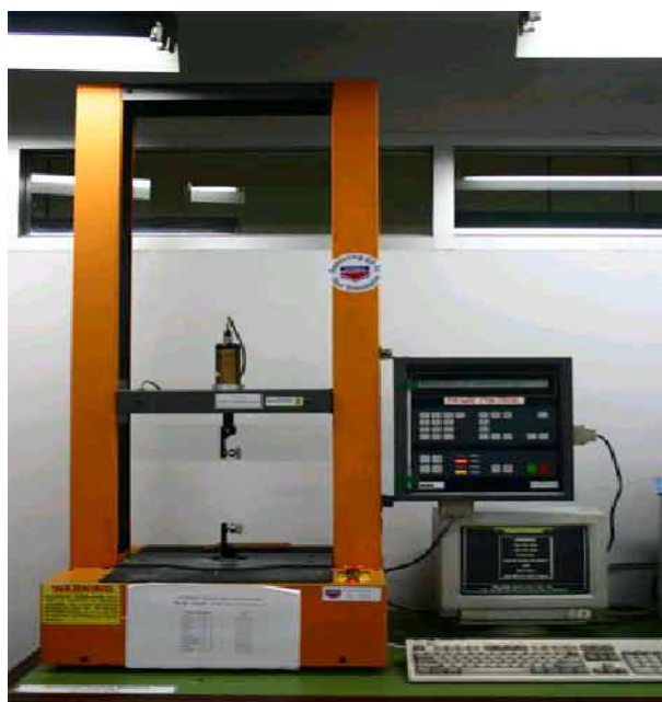
ภาพที่ 3.10 เครื่องทดสอบแรงดึง รุ่น L500 ของ LLOYD
