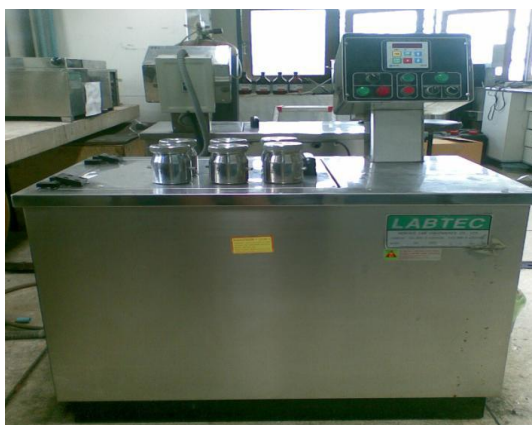
ภาพที่ 3.1 เครื่องย้อมแบบแช่ (Exhaustion) LABTEC
