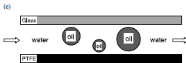
รูปที่ 4.5 แสดงลักษณะอนุภาคอิมัลชันที่มีขนาดเล็กไหลอยู่ระหว่างวัสดุที่เป็นตัวกลางชนิดแผ่น (Yoshihito, Masaaki, Hiroshi, Taisuke, and Kazuhiro, 2004 : 45.)
