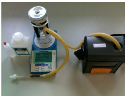
ภาพที่ 3.6 ชุดอุปกรณ์การปรับเทียบอัตราการไหลของปั๊มเก็บตัวอย่างอากาศ
