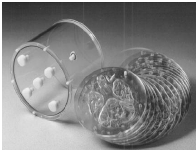
ภาพที่ 3. 4 แสดงสไลด์จำลองของสมองใน Hoffman 3D Brain Phantom (www.spect.com)
