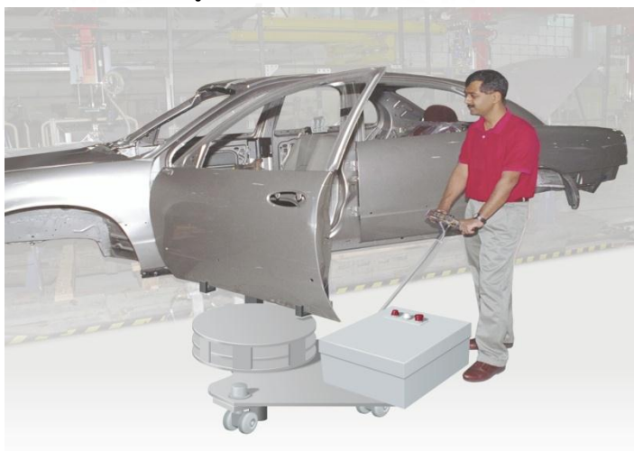
รูปที่ 1.1 การใช้โคบอทในภาคอุตสาหกรรม (Akella et al., 1999)
