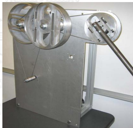
รูปที่ 2.12 โครงสร้างของโคบอทชนิดสวมใส่ส่วนไหล่ (Chua, 2006)
