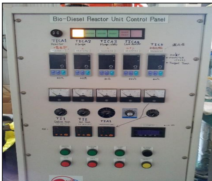
รูปที่ 3.3 แผงควบคุมอุณหภูมิของเครื่องปฏิกรณ์
