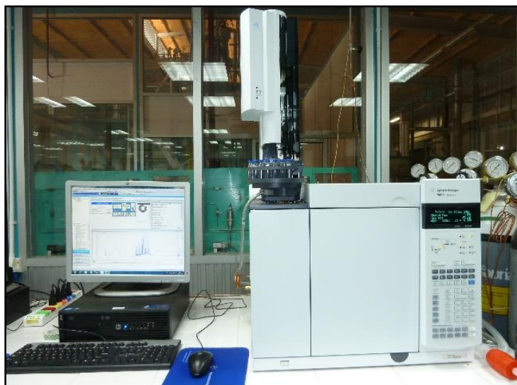
รูปที่ 3.5 เครื่องแก๊สโครมาโทกราฟีจำลองการกลั่น
