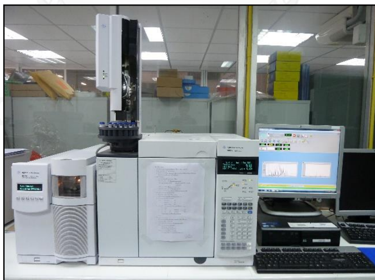
รูปที่ 3.6 เครื่องแก๊สโครมาโทกราฟี ประกอบด้วยแมสสเปกโตรมิเตอร์
