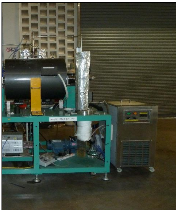
รูปที่ 3.4 อุปกรณ์ควบแน่นผลิตภัณฑ์
