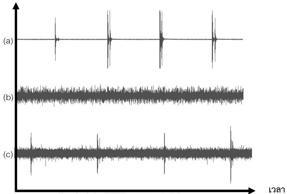
ภาพที่ 3-1 ลักษณะของสัญญาณอะคูสติก (a) Burst emission (b) Continuous emission (c) Mixed emission
