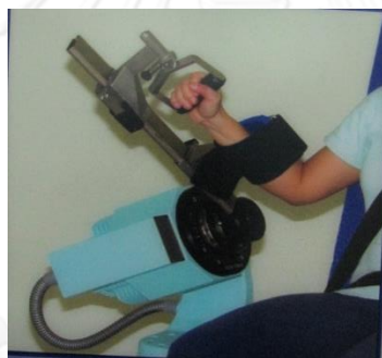
ภาพ 1 แสดงการวัดกำลังและความแข็งแรงของกล้ามเนื้อ โดยวัดจากข้อศอก
