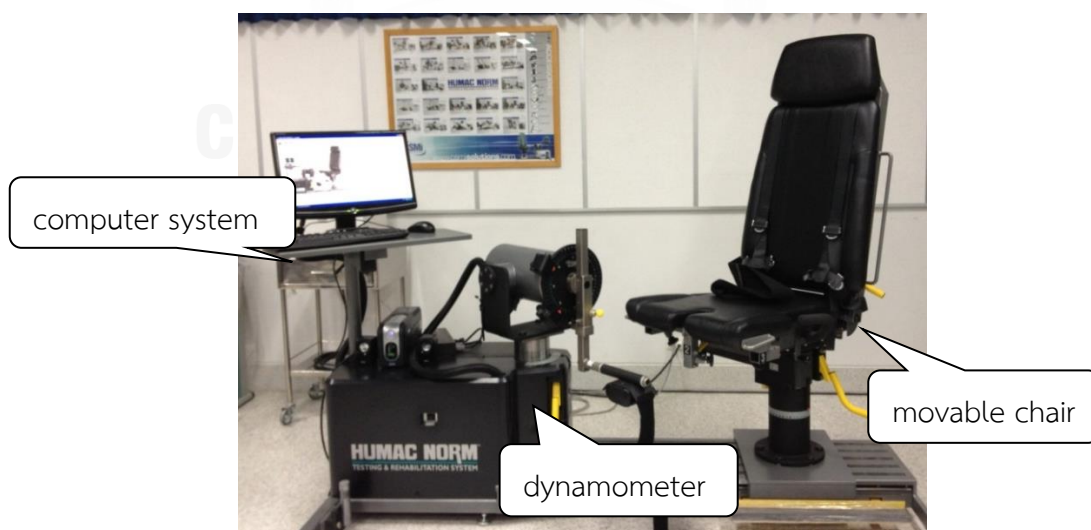
ภาพที่ 3.2 เครื่องทดสอบความแข็งแรงแบบไอโซไคนेटิกยี่ห้อ Humac Norm
