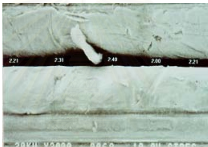
รูปที่ 35 : ตัวอย่างกลุ่มรอยเชื่อมต่อช่วงที่ 2 กำลังขยาย 2000 เท่า
