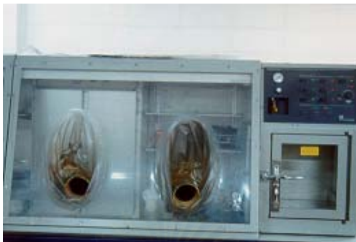
รูปที่ 11 : แสดงตู้ควบคุมสภาวะไม่มีออกซิเจน
