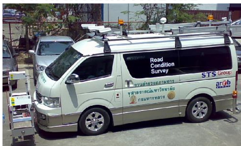
รูปที่ 1.1 รถสำรวจในโครงการศึกษาและวิเคราะห์ลักษณะสภาพความเสียหายของทาง
