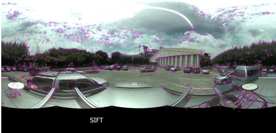
รูปที่ 5.10 ผลการหาจุดสนใจในภาพด้วยวิธี SIFT
