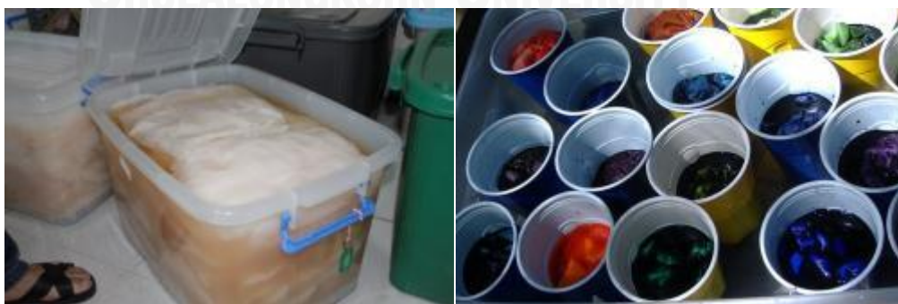
ภาพที่ 49 แผ่นเซลลูโลส แช่น้ำให้อิมตัว/แผ่นเซลลูโลสแช่สีให้ดูดซึมน้ำทั่วแผ่นและอิมตัว ที่มา: ภาพถ่ายโดย กฤษณ์ เย็นสุดใจ วันที่ 25 เมษายน 2554
