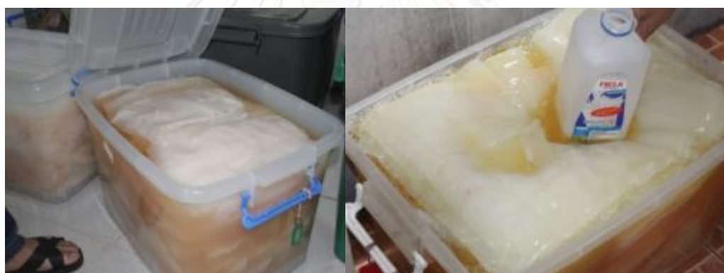
ภาพที่ 37 แผ่นแบคทีเรียเซลลูโลสครบกำหนดจะถูกนำไปแช่น้ำเพื่อให้อิมตัว ที่มา: ภาพถ่ายโดย กฤษณ์ เย็นสุดใจ วันที่ 21 เมษายน 2554
