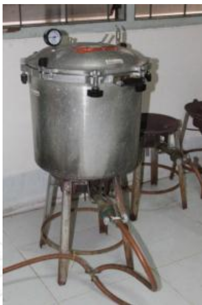
ภาพที่ 38 หม้อต้มฆ่าเชื้อแผ่นแบคทีเรียเซลลูโลส ที่มา: ภาพถ่ายโดย กฤษณ์ เย็นสุดใจ วันที่ 21 เมษายน 2554
