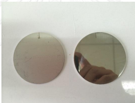
รูปที่ 4.6 เหล็กกล้าโรสนิม ด้านซ้ายก่อนและด้านขวาหลังการขัดผิวหน้า
