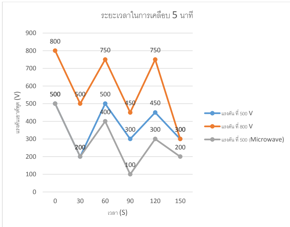
รูปที่ 4.8 กราฟแสดงความสัมพันธ์ระหว่างเวลา กับแรงดันไฟฟ้าเอาต์พุต ที่เวลา 5 นาที
