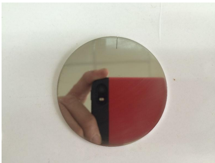
(ก). ชิ้นงานสำหรับวัสดุที่ต้องการเคลือบแผ่นเหล็กกล้าโรสนิม ชนิด 304
