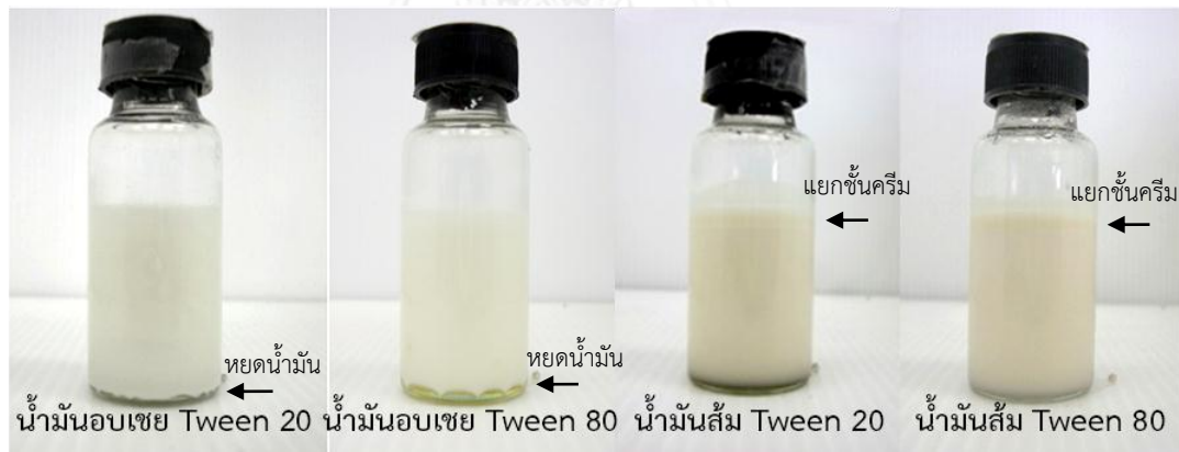
รูปที่ 4.2 การแยกชั้นของอิมัลชันน้ำมันหอมระเหยร้อยละ 5 โดยน้ำหนัก ตัวทำอิมัลชันร้อยละ 0.8 โดยน้ำหนัก
