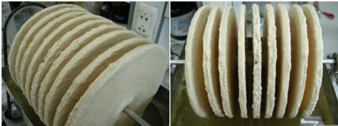
ภาพที่ 4.14 แผ่นอะคริลิกติดด้วยผ้าขาวบางที่มีจุลินทรีย์เกาะความหนา 1.5 มิลลิเมตรเมื่อสิ้นสุดการผลิตกรดไขมันแบบกึ่งกะ
