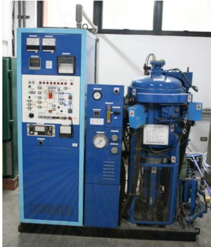
รูปที่ 3.3 เตาเผาอุณหภูมิสูงควบคุมบรรยากาศ (Hi-Multi 5000, Fujidempa, Japan)
