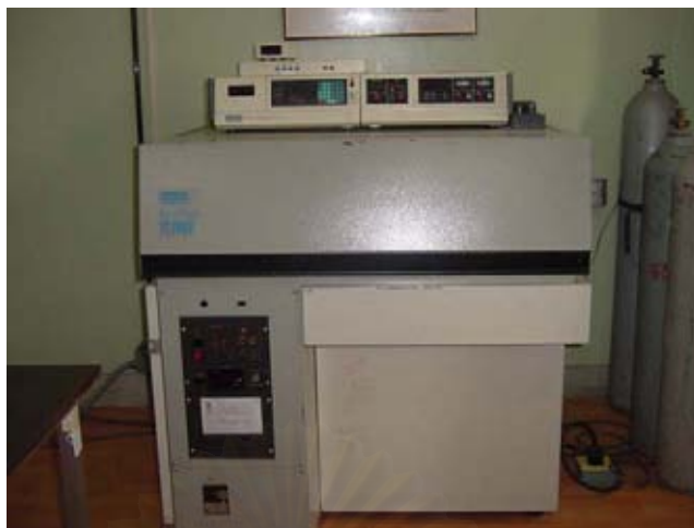
รูปที่ 3.15 เครื่อง Laser Flash Thermal Analyzer (ULVAC, TC-7000)
