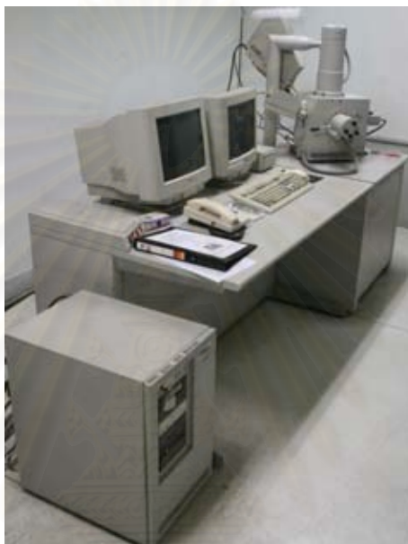
รูปที่ 3.14 เครื่อง Scanning electron microscope (XL 30CP, Philips)
