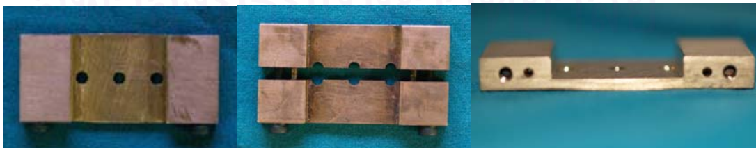
รูปที่ 4 แสดงแม่แบบทองเหลืองขนาดเส้นผ่านศูนย์กลาง 3 มิลลิเมตร สูง 2 มิลลิเมตร
