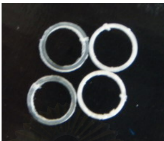
รูปที่ 8 แสดงแม่แบบ โพลีเอททิลีนขนาดเส้นผ่าศูนย์กลาง 9 มิลลิเมตร สูง 1.5 มิลลิเมตร
