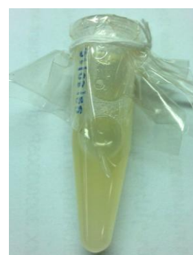
นำต่อมไหมส่วนหลังผสมกับ สารละลายลิเทียมโบรไมด์ ความเข้มข้น 9.3 โมลาร์
