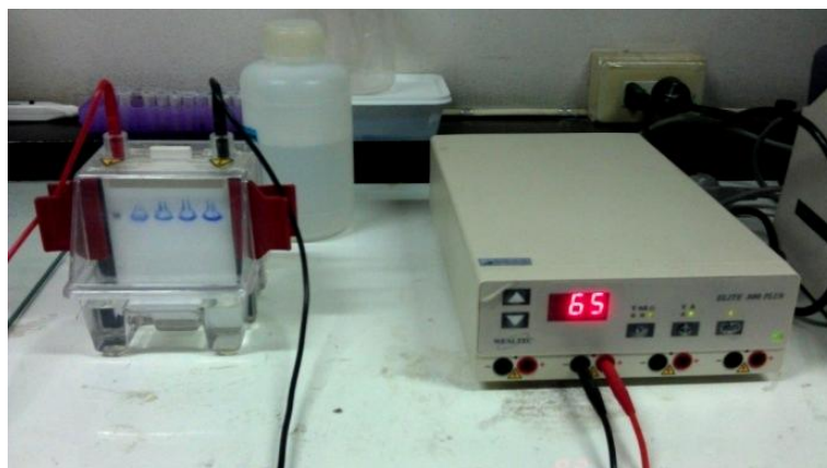
รูปที่ 3.4 ชุดอุปกรณ์อิเล็กโทรโพสิซแบบแนวตั้งที่ต่อเข้ากับแหล่งจ่ายไฟฟ้า
