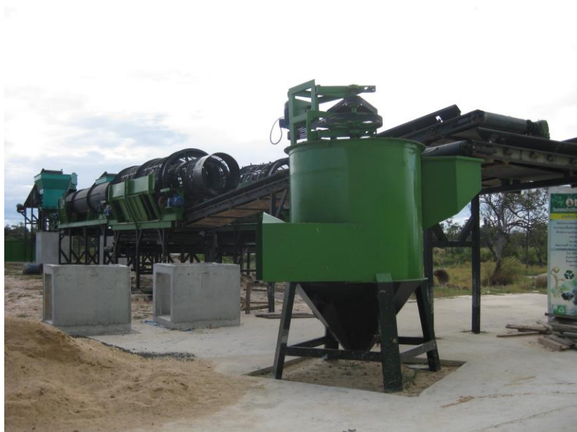
รูปที่ 2.38 เครื่องจักรคัดแยกและสายพานลำเลียงขยะ บจก. เมืองสะอาด
