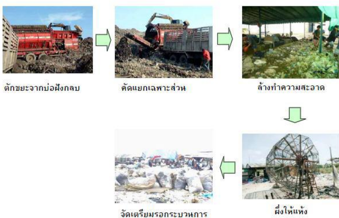
รูปที่ 2.4 แผนผังการจัดเตรียมวัตถุดิบเพื่อแปรรูปพลาสติกเป็นน้ำมัน
