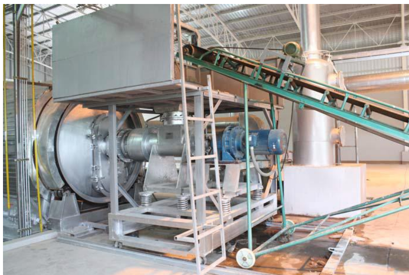
รูปที่ 2.36 ระบบสายพานลำเลียงป้อนเข้าสู่เครื่องปฏิกรณ์แบบต่อเนื่องศรีเบญจลักษณ์
