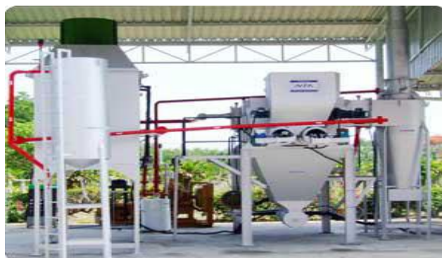
รูปที่ 2.27 เครื่องไพโรไลซิส ขนาด 5 ตันต่อวัน บจก. พร้อมมาก
