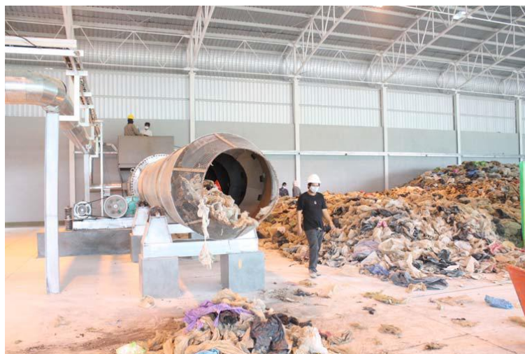
รูปที่ 2.35 ระบบย่อยและอบแห้งความชื้น บจก. ศรีเบญจลักษณ์
