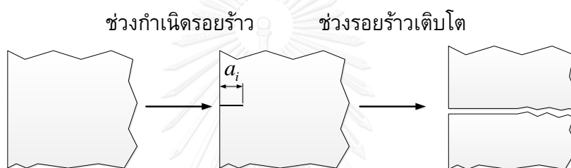
รูปที่ 2.13 กระบวนการเกิดความเสียหายล้า
