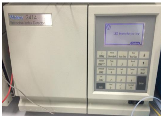
รูปที่ 3.17 เครื่องวิเคราะห์น้ำหนักโมเลกุล gel permeation chromatography (GPC) ส่วน detector
