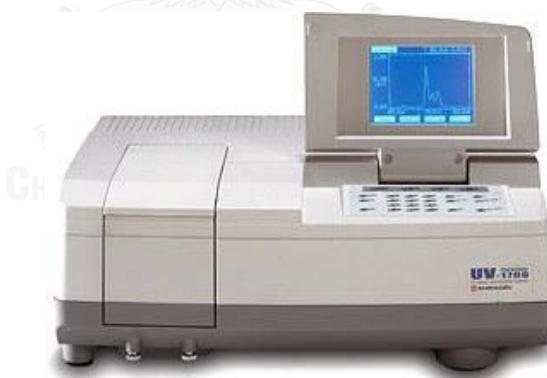
รูปที่ 3.11 เครื่องดูดกลืนด้วยแสง (UV-Visible Spectroscopy) รุ่น Shimadzu UV-1700
