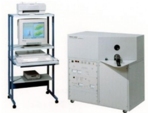
รูปที่ 3.13 เครื่องวิเคราะห์ผิววัสดุ (X-ray Photoelectron Spectroscopy)
