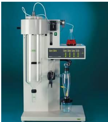
รูปที่ 3.6 เครื่องอบแห้งแบบพ่นฝอย รุ่น B-290
