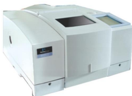
รูปที่ 3.15 เครื่องมือวิเคราะห์ฟูเรียร์ทรานสฟอร์มอินฟราเรดสเปกโทรสโกปี รุ่น Nicolet 6700
