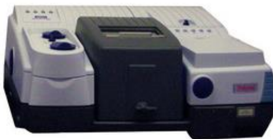
รูปที่ 3.15 เครื่องมือวิเคราะห์ฟูเรียร์ทรานสฟอร์มอินฟราเรดสเปกโทรสโกปี รุ่น Nicolet 6700
