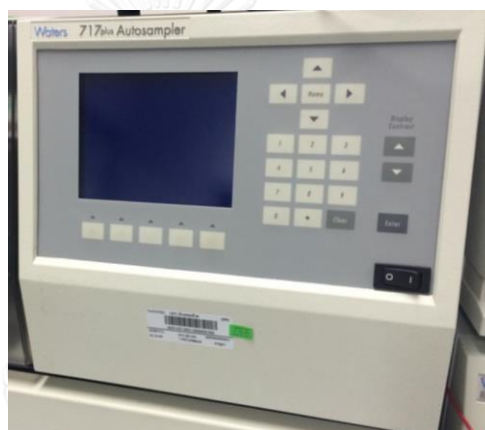
รูปที่ 3.18 เครื่องวิเคราะห์น้ำหนักโมเลกุล gel permeation chromatography (GPC) ส่วน Auto sample
