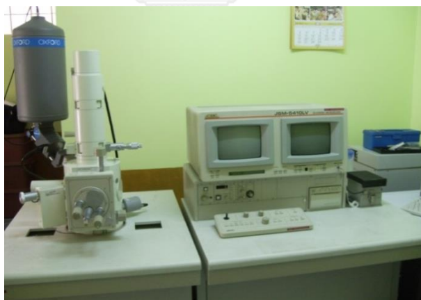
รูปที่ 3.14 กล้องจุลทรรศน์อิเล็กตรอนแบบส่องกราด (JEOL รุ่น JSM-5410LV)
