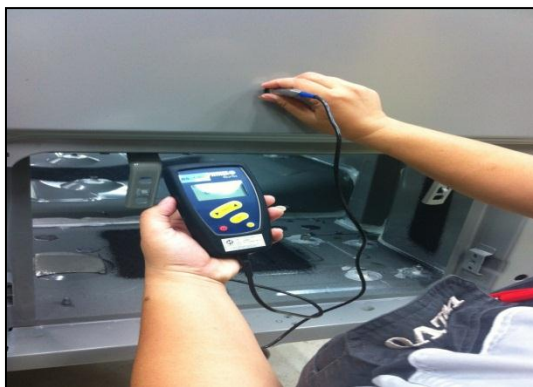
รูปที่ 5.2 การนำเครื่อง Coating Thickness Gauge วัดบนผิวชิ้นงาน
