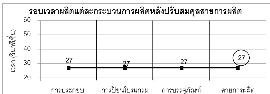
ภาพที่ 71 แสดงรอบเวลาผลิตในแต่ละส่วนการผลิต (หลังปรับปรุง)
