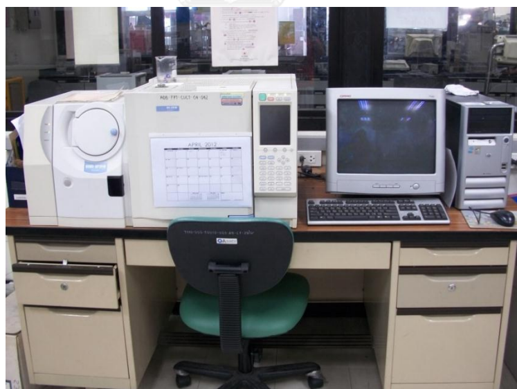
รูปที่ 3.7 เครื่องแก๊สโครมาโทกราฟี-แมสสเปกโตรเมตรี (Gas chromatography-mass spectrometry, GC-MS)
