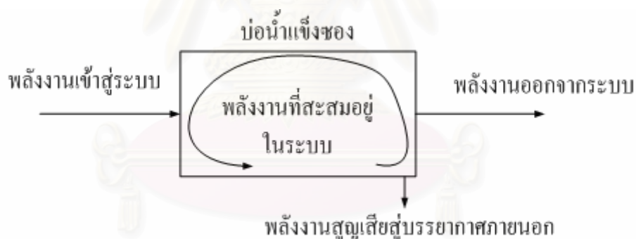
รูปที่ 3.3 การหมุนเวียนของพลังงานในบ่อน้ำแข็ง
