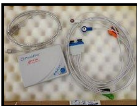
ภาพที่ 4 เครื่องวัดปริมาตรเลือดที่ออกจากหัวใจ
