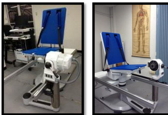
ภาพที่ 6 เครื่องวัดความแข็งแรงของกล้ามเนื้อแบบไอโซคิเนติก (Isokinetic)
