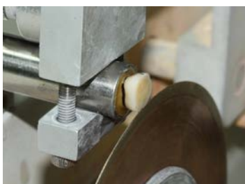
รูปที่ 1 การตัดส่วนบดเคี้ยวของซี่ฟันโดยมีน้ำหล่อเลี้ยงตลอดเวลาของการตัดแต่ง
