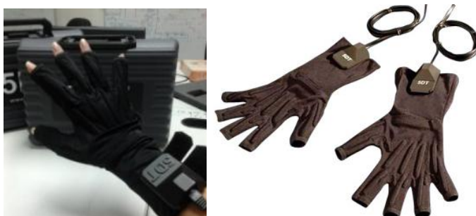
รูปที่ 2.3 ถุงมือรับข้อมูล 5DT 14 Data Glove Ultra [9]
