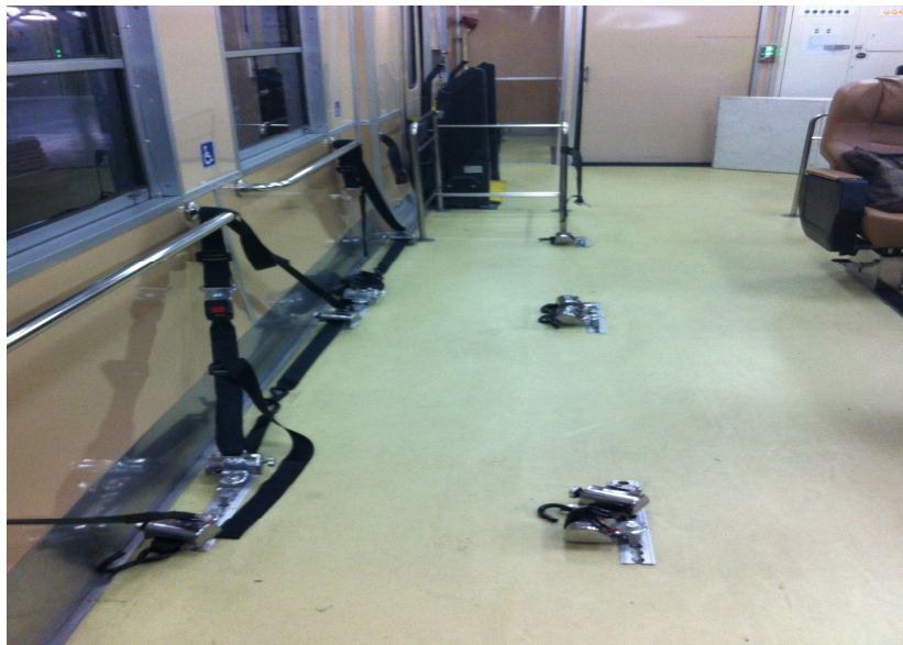
ภาพที่ 12 ที่ยึดรถวีลแชร์บนรถไฟสำหรับคนพิการ
