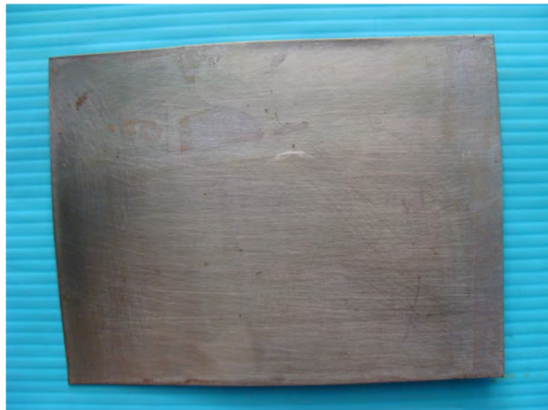
รูปที่ 4.7 แผ่นเหล็กเคลือบผิวแข็ง สูตรที่ 6
