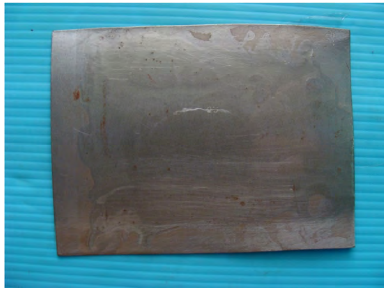
รูปที่ 4.5 แผ่นเหล็กเคลือบผิวแข็ง สูตรที่ 4
