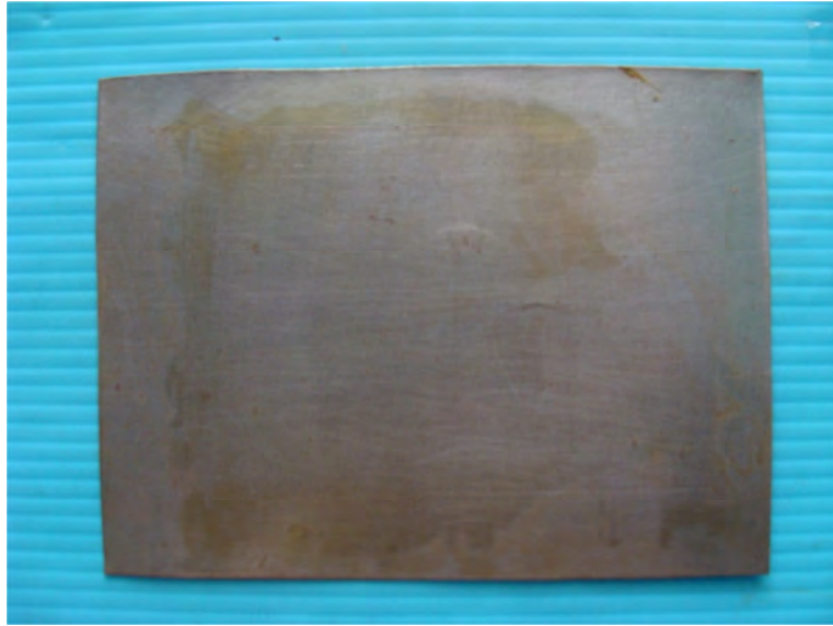
รูปที่ 4.4 แผ่นเหล็กเคลือบผิวแข็ง สูตรที่ 3
