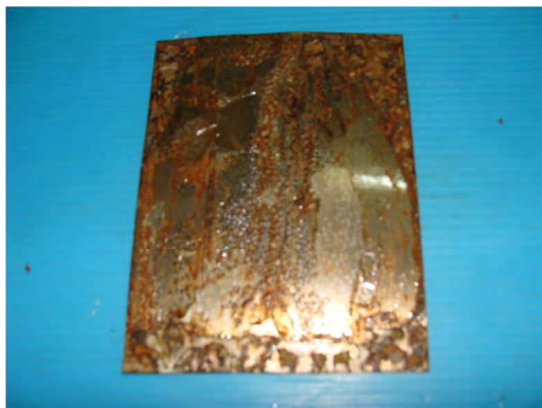
รูปที่ 4.24 แผ่นเหล็กเคลือบผิวแข็ง สูตรที่ 5
