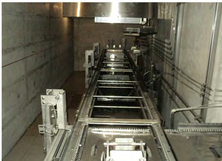
รูปที่ 3.2 บริเวณที่อนุภาคอิเล็กตรอนฉายผลิตกัมมันต์
