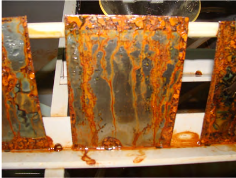
รูปที่ 4.17 แผ่นเหล็กเคลือบผิวแห้ง สูตรที่ 7
