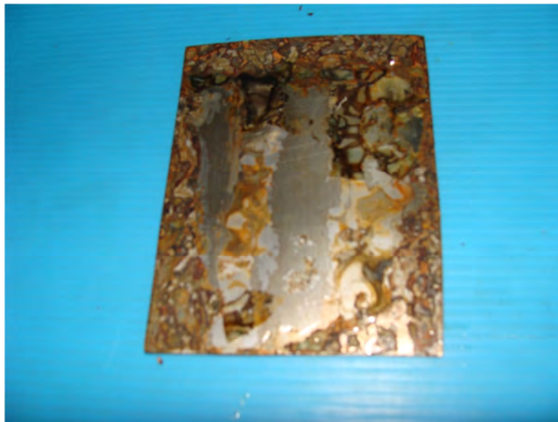
รูปที่ 4.23 แผ่นเหล็กเคลือบผิวแข็ง สูตรที่ 4
