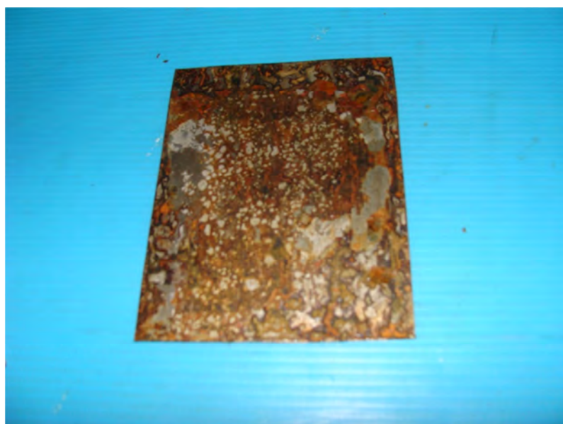
รูปที่ 4.22 แผ่นเหล็กเคลือบผิวแห้ง สูตรที่ 3
