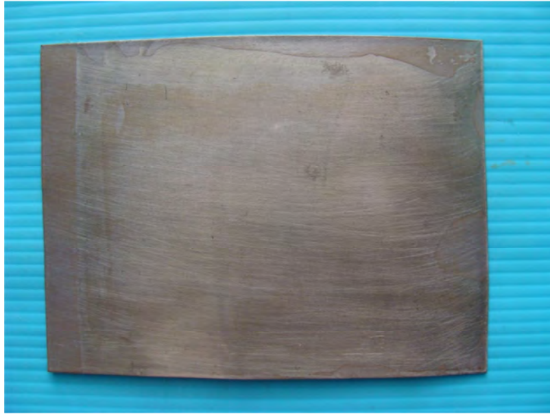
รูปที่ 4.8 แผ่นเหล็กเคลือบผิวแข็ง สูตรที่ 7
